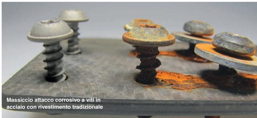
Massiccio attacco corrosivo a viti in acciaio con rivestimento tradizionale
